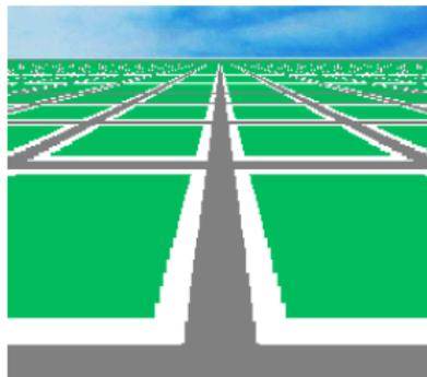
Un pixel est projeté à l'écran en utilisant une transformation affine (qui peut être spécifique à chaque ligne) comportant 6 paramètres :  $a$ ,  $b$ ,  $c$  et  $d$  pour la transformation et  $x_0$  et  $y_0$  pour l'origine de la transformation.
